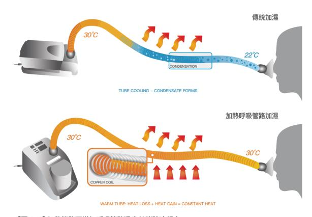
【圖 2-3】加熱管路可增加呼吸管路濕度並消除冷凝水。
