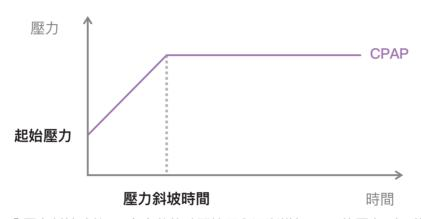
【圖 2-4】壓力斜坡功能,可在定義的時間範圍內逐漸增加 PAP 的壓力,直到設定的治療壓力。
